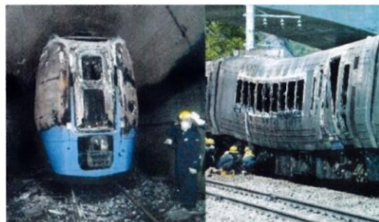
トンネル車両火災の例：JR 石狩線特急事故（2011.5.27）
